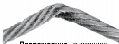
Повреждение , вызванное неправильным использованием (например, фиксацией нагрузки на тросе)
